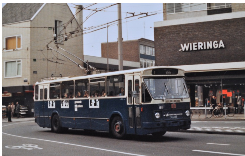
Trolley 161, bouwjaar 1969, gedeeltelijk hergebruik tractie van gesloopte voertuigen Verheul carrosserie Roggestraat (tegenwoordig Johnny van Doornplein) Foto Paul van Onzen
