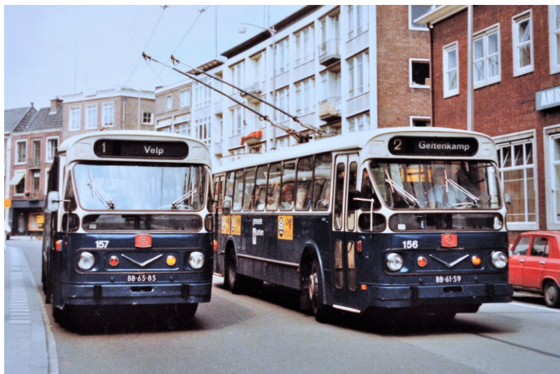
Trolleys 156 en 157, bouwjaar 1967, hergebruikte BUT-tractie van gesloopte voertuigen, Verheul-carrosserie in de Looierstraat op 11 mei 1972 Foto Paul van Onzen
